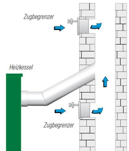
Auch in Kaminen funktioniert der Zugbegrenzer gut. Der untere Einbauort empfiehlt sich bei Festbrennstoffflöten, weil der Rußanfall dort geringer ist.
