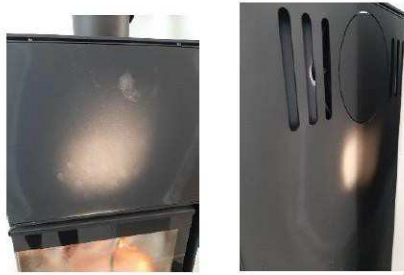
Abbildung 10. Beispiele der Verfärbungen, die infolge der Überhitzung des Gerätes entstanden.
