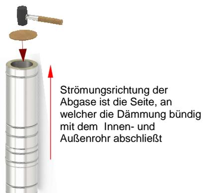
Bild 4: Verbinden der Elemente
