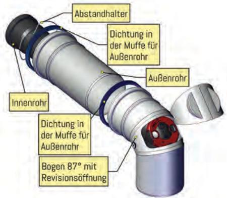
Die Details der Verbindung der Innenrohre und Formteile sind in der Montageanleitung PolyLine PP Starr detailliert ausgeführt
